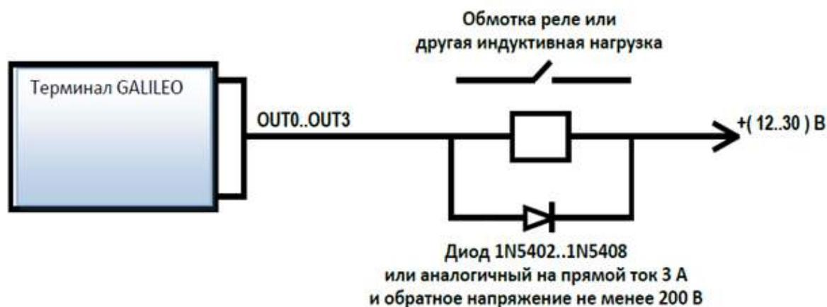
Рисунок 17. Схема подключения реле к выходам OUT0..OUT3.
