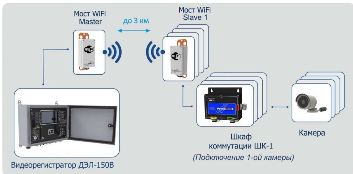
Рисунок 30. Пример №2 обобщенной блок-схемы подключения ДЭЛ-150В2
