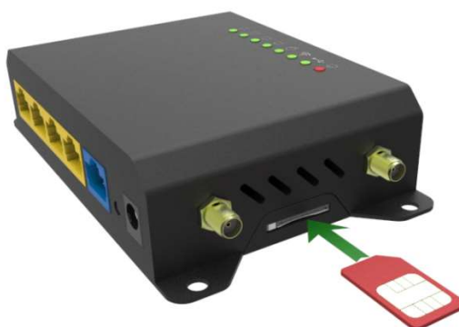
Рисунок 34. Пример установки Sim-карты
