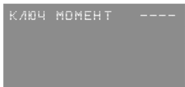
Рисунок 16. Показания при потере связи с ДН-130В
