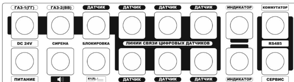
Рисунок 26. Пример подписи разъемов модуля управления (модуля коммутации)
