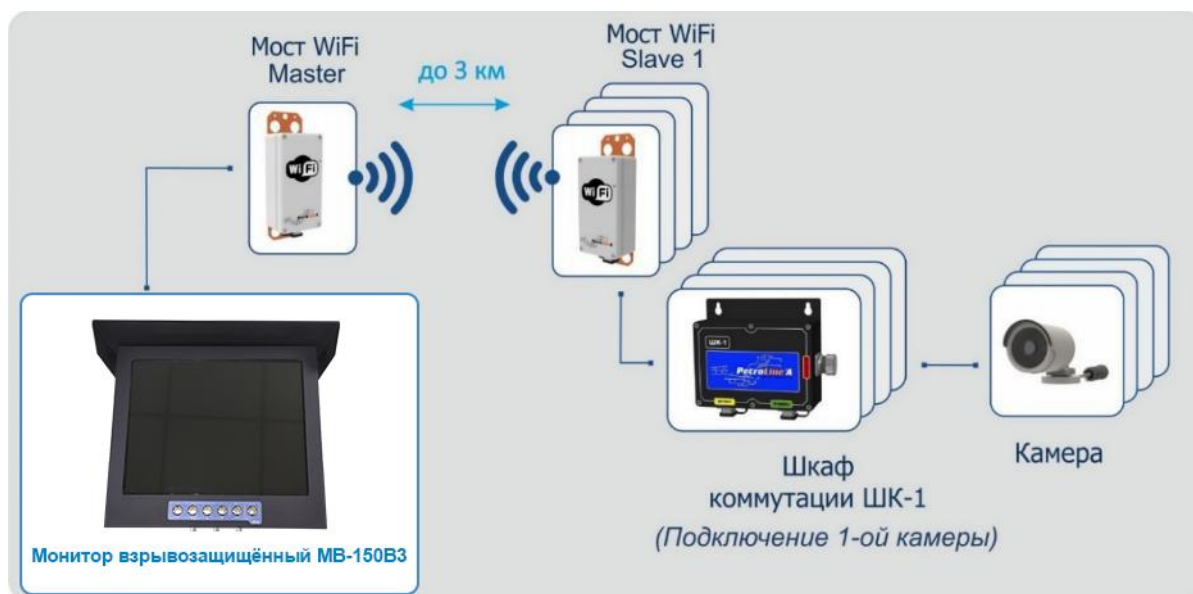
Рисунок 25. Пример №2 обобщенной блок-схемы подключения МВ-150В3
