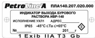
Рисунок 8. Пример маркировки ИБР-140
