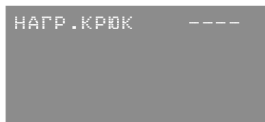
Рисунок 13. Показания при потере связи с ДН-130
